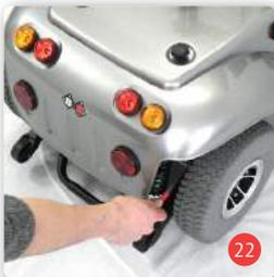
Wollen Sie den Scooter in bestimmten Situationen schieben, müssen Sie die Bremsen entriegeln. Im Freilauf ist der Scooter leicht zu schieben.
