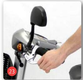
Das Parken und Feststellen der Bremse erfolgt durch Verriegeln des Antriebs. Dazu ist der Scooter durch eine Hilfsperson und/oder durch den Einsatz der manuellen Betriebsbremse zum Stehen zu bringen. Anschließend ist die elektro-magnetische Bremse zu betätigen, wie in Abbildung 22 dargestellt.
