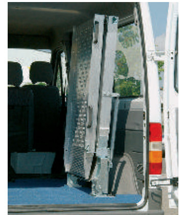
Die RRD-Rampe ist nach innen und außen drehbar.
